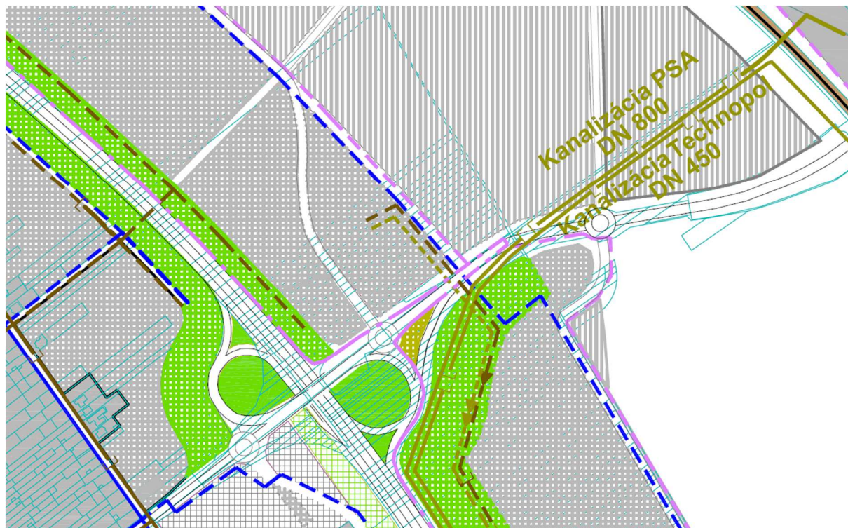
Obr. č. 12: Výkres navrhovaného riešenia vereného technického vybavenia, Energetika a spoje podľa ÚPD mesta Trnava
