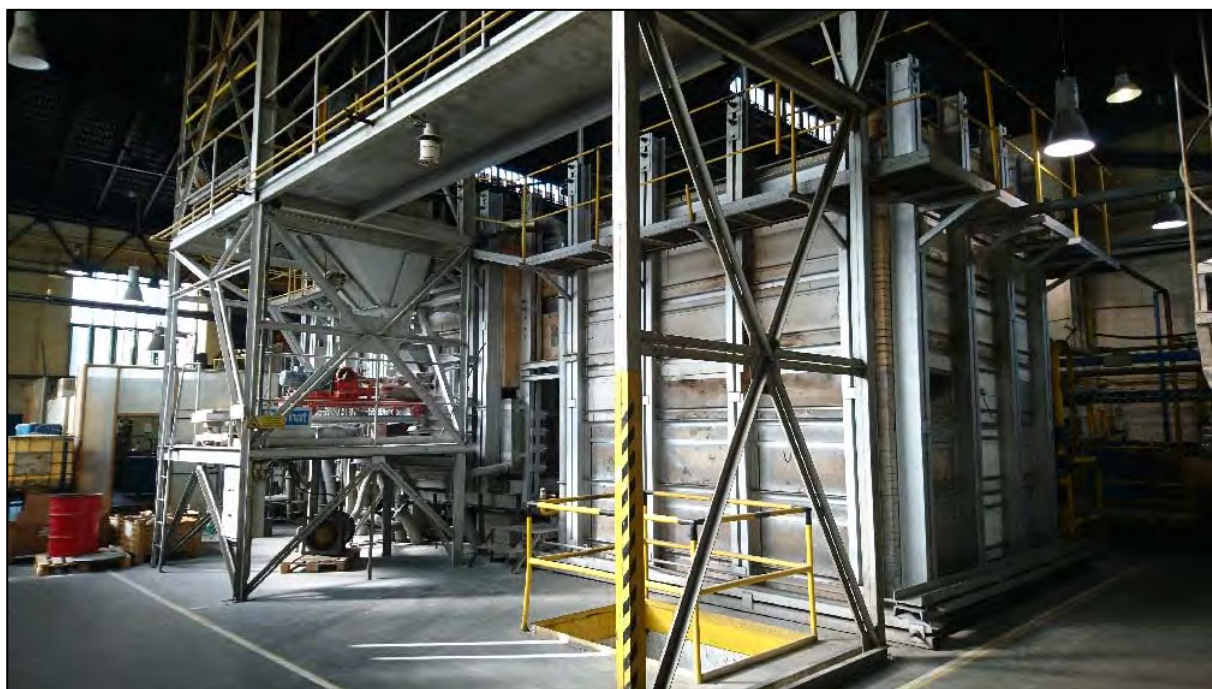
Obrázok 2: Zakladanie sklárskej vsádzky a rekuperátor taviaceho agregátu č. 4
