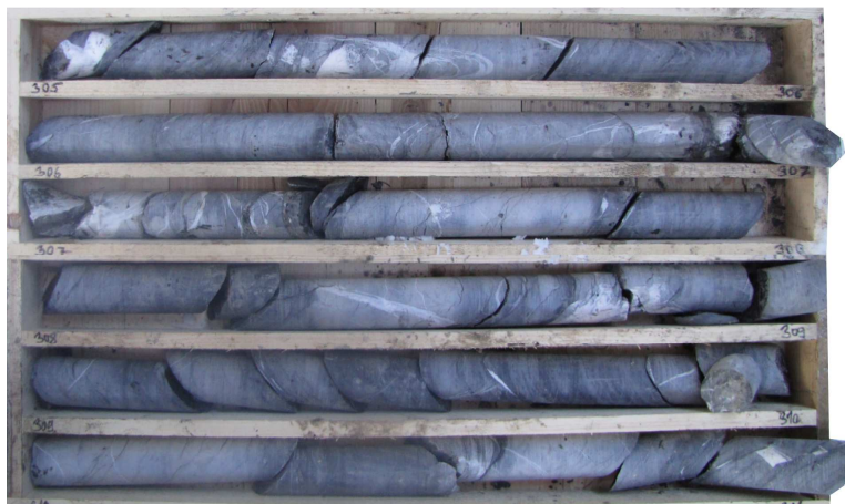
Obrázok 10 Kompaktné zdravé slienité vápence s prechodmi do vápnitých ílovcov
