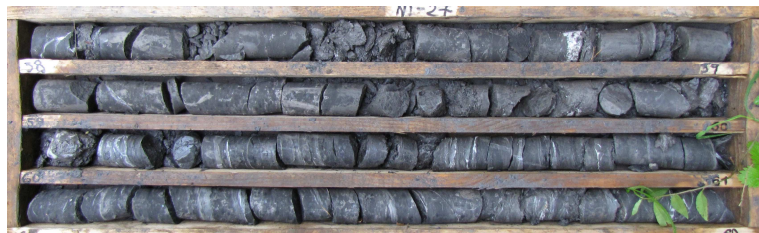
Obrázok 7 Rozpukané navetrané ílovce s laminami siltovca, rozpadavé pozdĺž plôch vrstevnatosti
