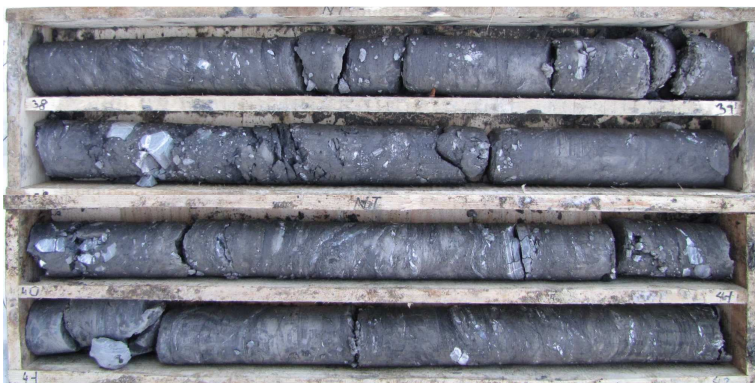
Obrázok 6 Tektonicky porušené ílovce s plávajúcimi úlomkami pevnejších hornín – tektonická brekcia
