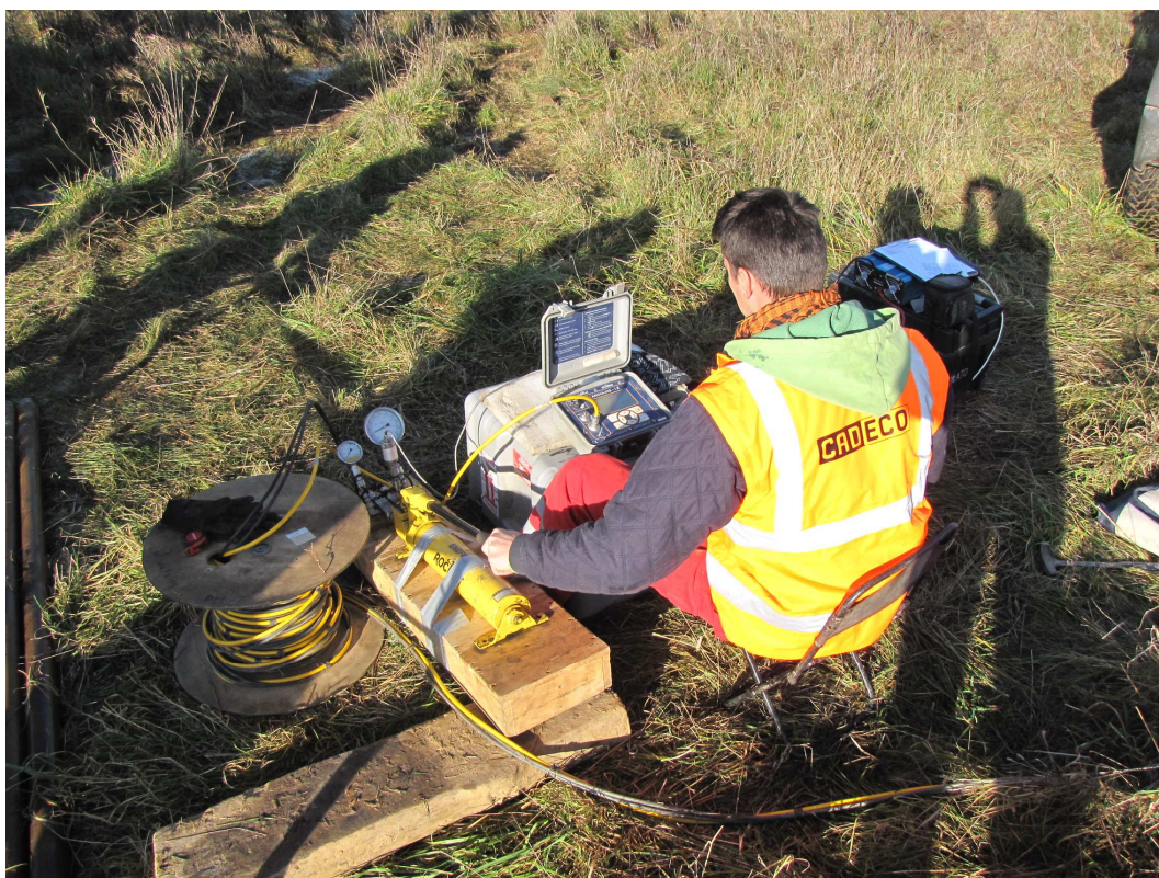
Obrázok 1 Realizácia dilatometrickej skúšky - tlakovanie pomocou hydraulického pumpy a odčítanie hodnôt tlaku a objemu pomocou dataloggera
