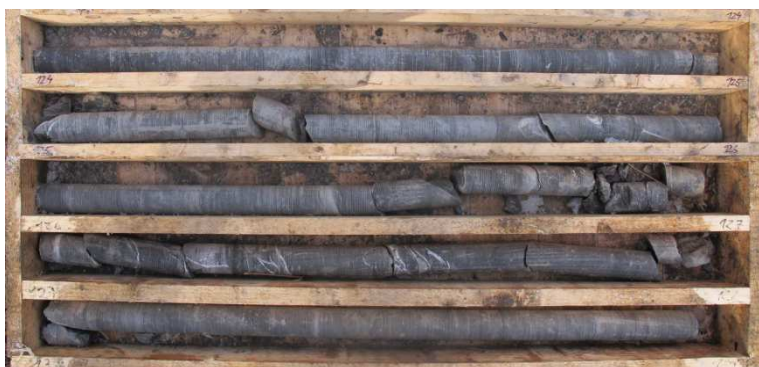
Obrázok 8 Kompaktné zdravé málo porušené ílovce s laminami siltovca
