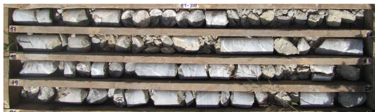
Obrázok 9 Tektonicky porušené a zvetrané slienité vápence s preplástkami zbridlčatených vápenných ílovcov (vypláchnuté počas vŕtania)
