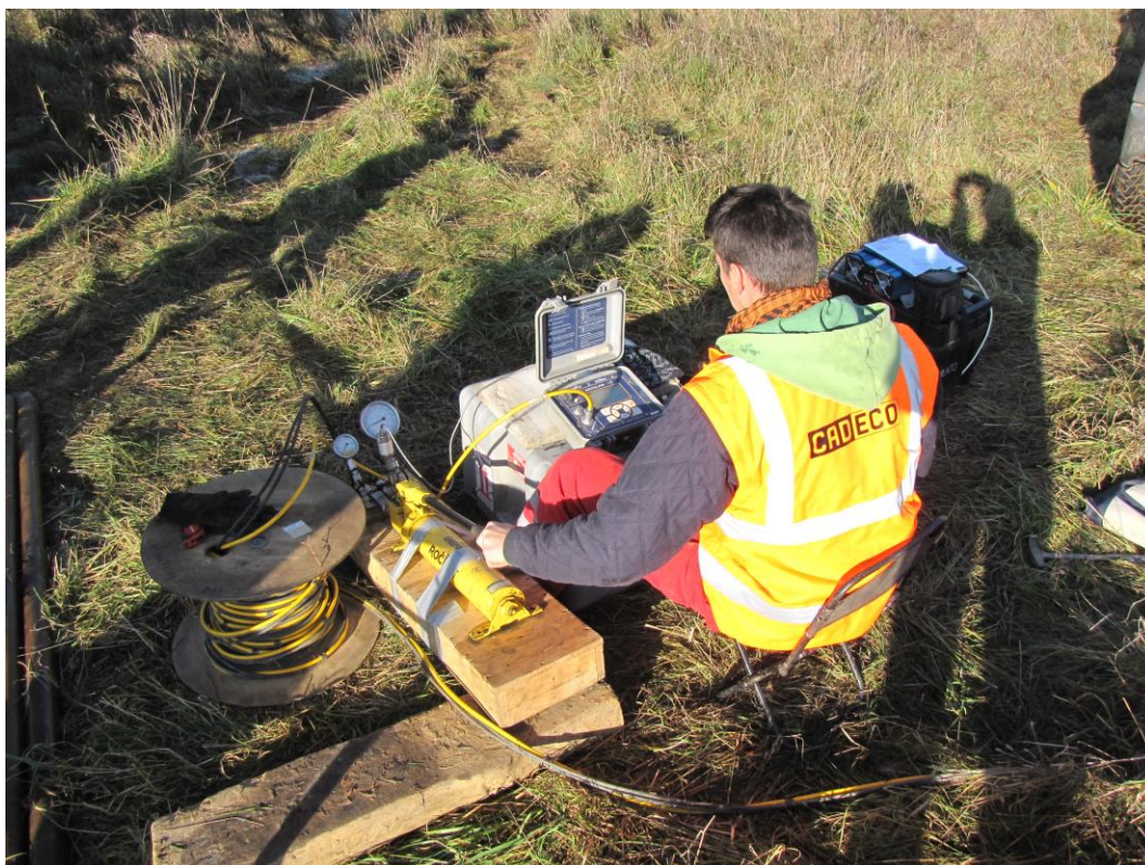
Obrázok 1 Realizácia dilatometrickej skúšky - tlakovanie pomocou hydraulickéj pumpy a odčítanie hodnôt tlaku a objemu pomocou dataloggera
