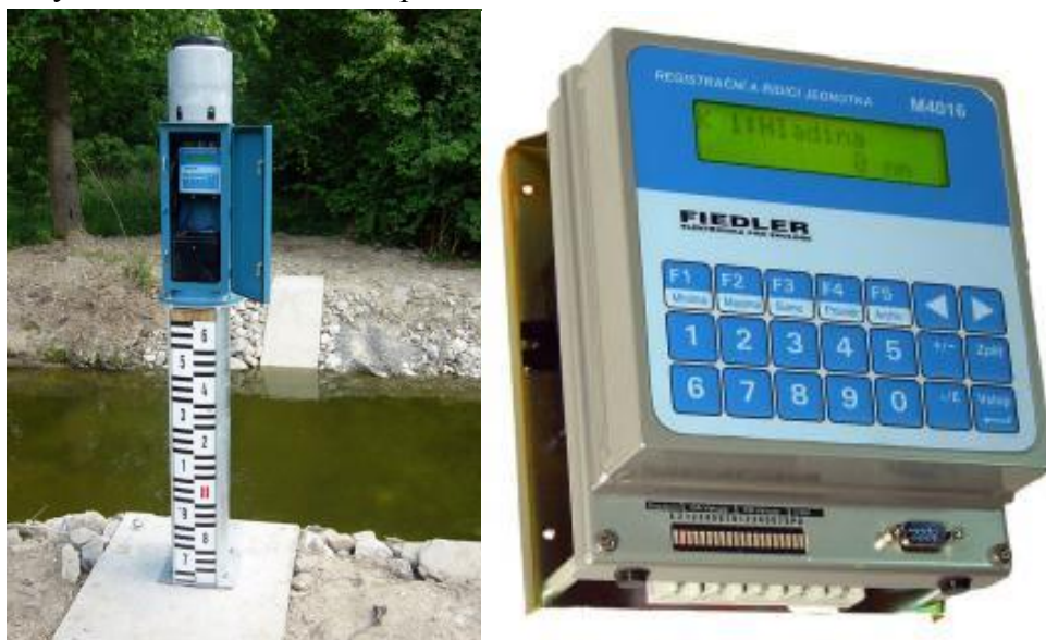
Obr.č.8 . Vodomerný profil na predprahu odbernej prehrádzky Foto : www.fiedler-magr.cz
