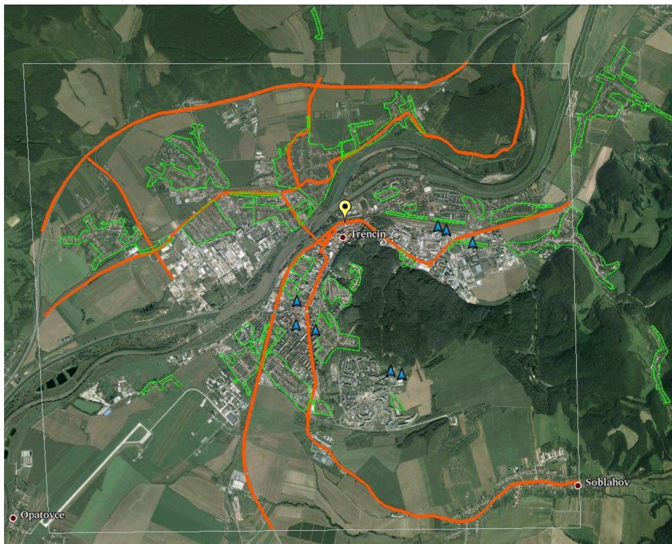
Obr. 5 Zdroje PM10 v okolí monitorovacej stanice. (Modré značky – bodové zdroje z NEIS, zelené čiary ohraničujú oblasti s predpokladanými lokálnymi kúreniskami, oranžové čiary – sčítacie úseky ciest podľa SSC.
