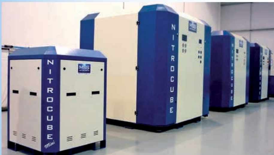
Systém na báze generátorov dusíka
