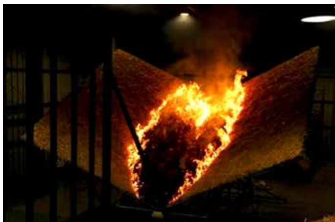
Obr. 1 a 2 zobrazujú laboratórne experimenty pre rôzne tvary plôch terénu a vplyvu vetra
