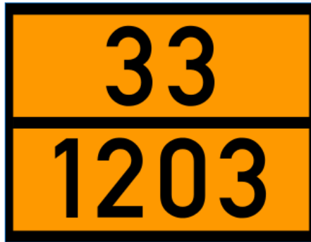
Identifikačné číslo nebezpečnosti látky (horný riadok čísel) na výstražnej tabuľke
