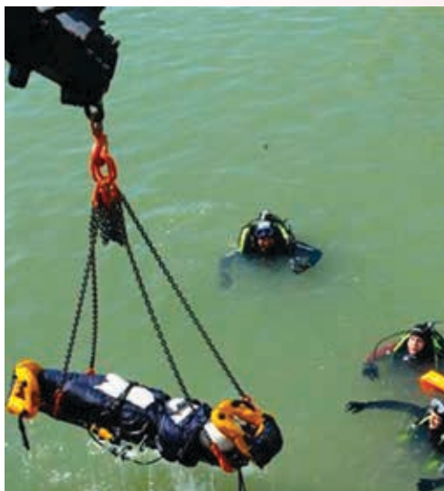
Zavesené plávajúce nosidlá pod vrtuľník, pre leteckú záchranu z vodnej hladiny
