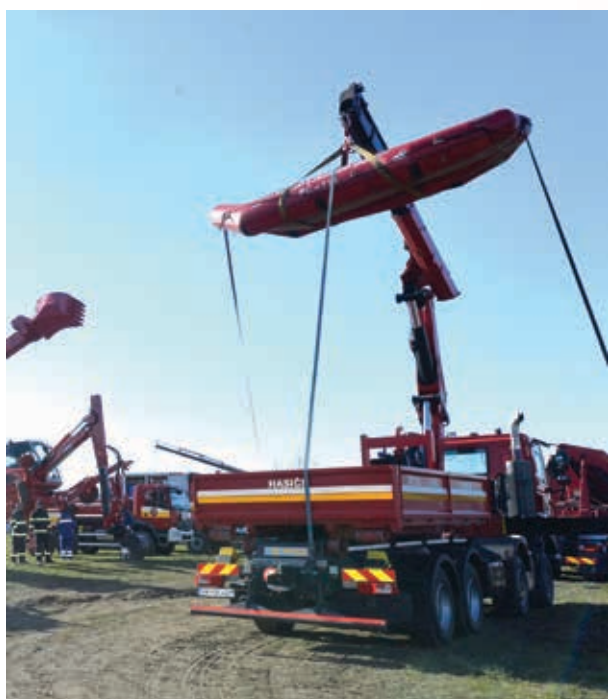
Automobilový nosič kontajnerov 8x8 na podvozku TATRA Phoenix
