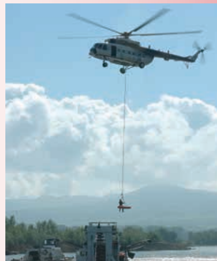
Zavesené plávajúce nosidlá pod vrtuľník, pre leteckú záchranu z vodnej hladiny
