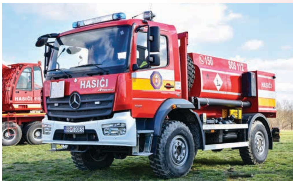
Mobilná cisterna na podvozku Mercedes Benz Atego pre zásobovanie palivom
