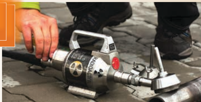
Ukážka kontroly kvality zvaru pomocou prístroja osadeného silným žiaričom, ktorý sa vysúva z tienenia prístroja iba na veľmi krátku dobu, nevyhnutnú na meranie
