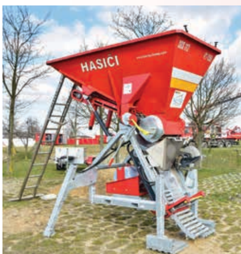
Dávkovač s násypníkom pre plnenie vriec s pieskom
