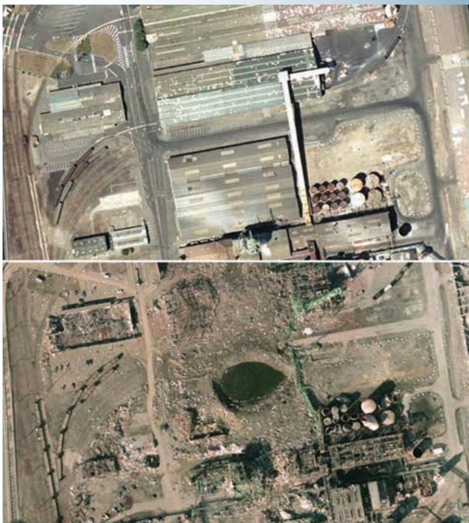
Továrň v Toulouse pred katastrofou (horný obrázok) a po katastrofe (dolný obrázok). Na obrázku je vidieť kráter, ktorý vznikol v dôsledku výbuchu. Po niektorých budovách však neostala ani stopa
