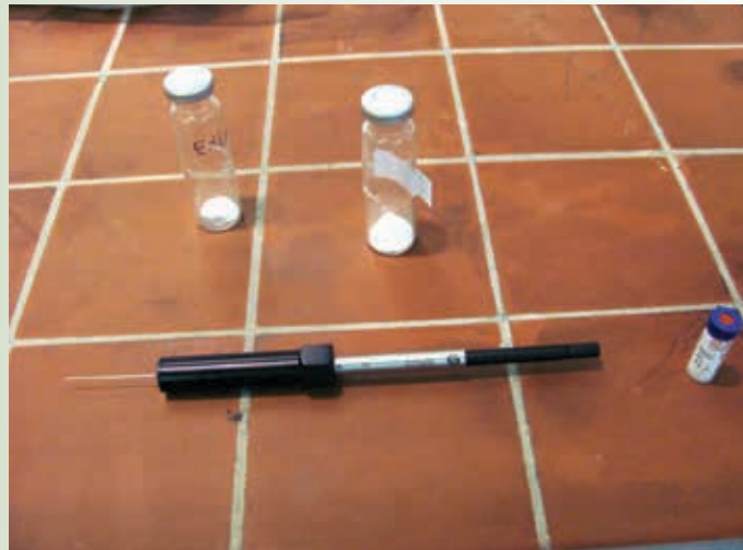
Nástroj na ručné vykonávanie mikroextrakcie (plynných alebo kvapalných látok) na špeciálnom sorpčnom vlákne SPME, ktoré sa potom tepelne desorbuje v nástreku GCMS
