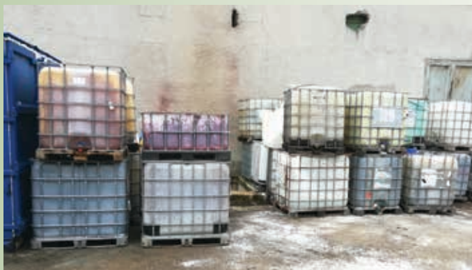
Takto nemá byť uložený nebezpečný odpad. Objekt nie je chránený proti vniknutiu nepovolaných osôb
