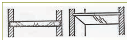
Základné typy trhlín v stenách a v múroch
