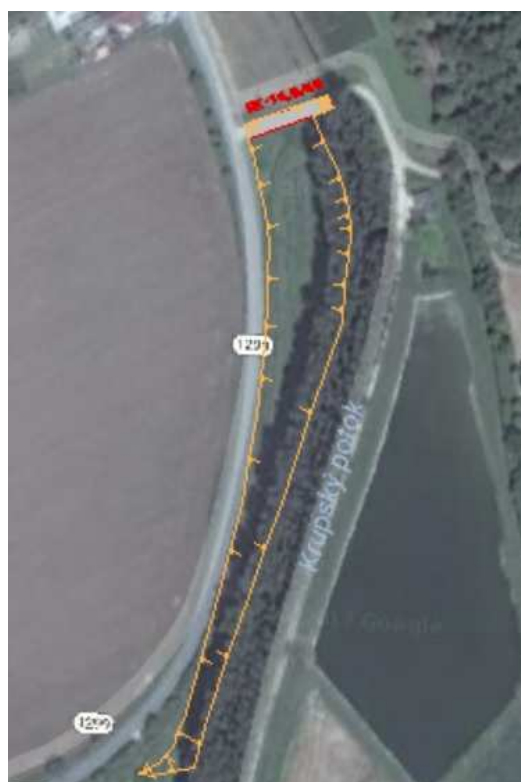
Obr. č. 6: Navrhovaná sieť miestnych obslužných komunikácií s napojením na existujúce komunikácie
