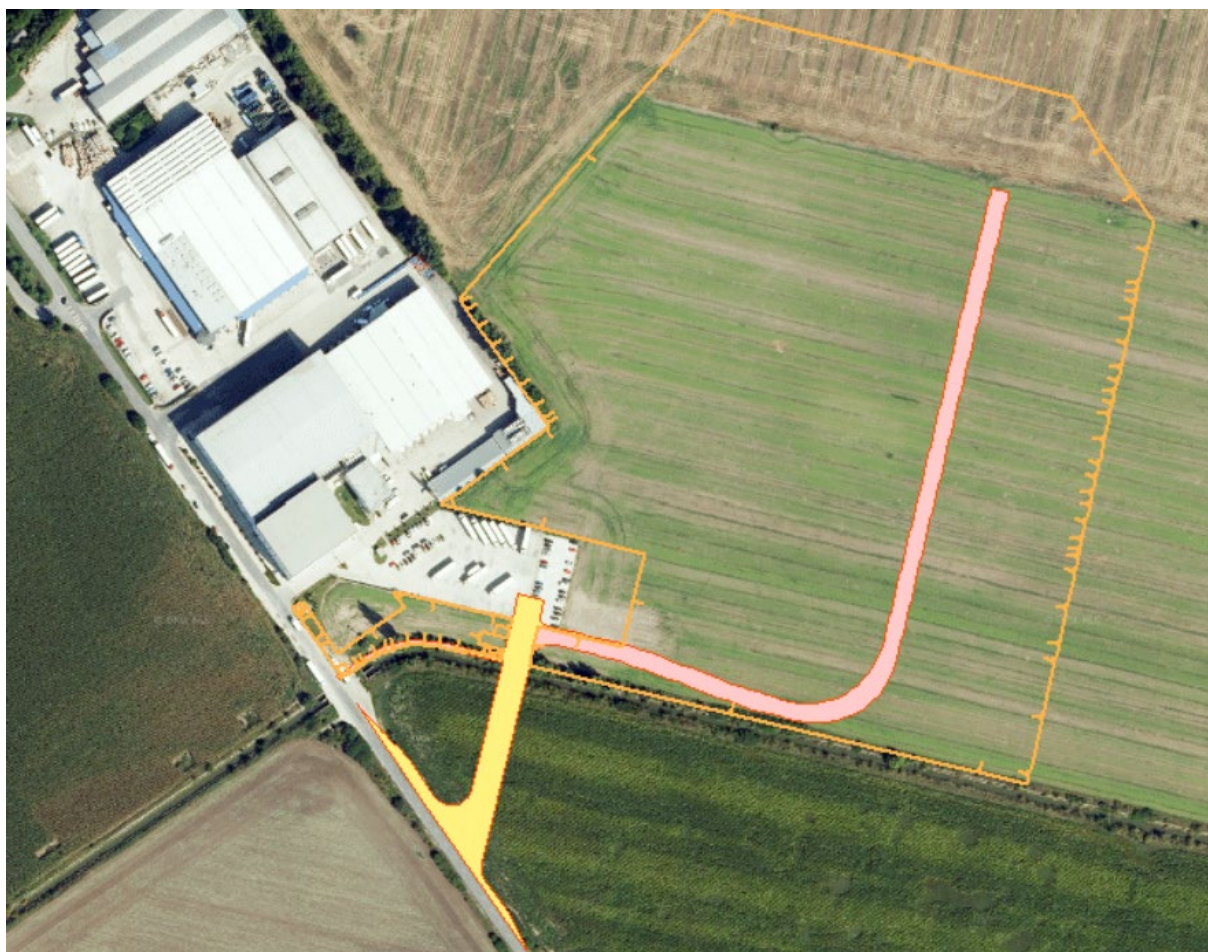
Obr. č. 7: Navrhovaná sieť miestnych obslužných komunikácií s napojením na existujúce komunikácie (III/1267)
