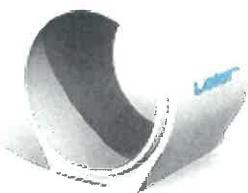
Tradičná rúra na klasický spoj. Výhody: vytvorenie bezpečného potrubného spoja, pripravený spevnený podklad. Rúry sú v prevedení na pero a drážku so spájaním na kľúč. Menovitá dĺžka je 1,0 m, priemery 300 - 1000 mm. Ostatné špecifikácie nájdete v tabuľke.
