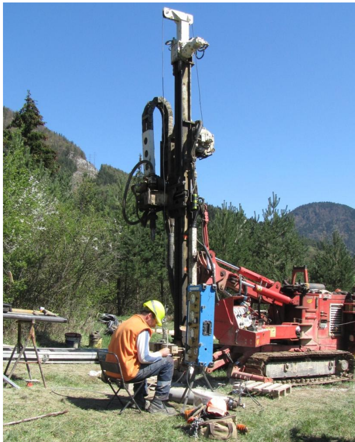
Obr. 1: Realizácia presiometrickej skúšky.
