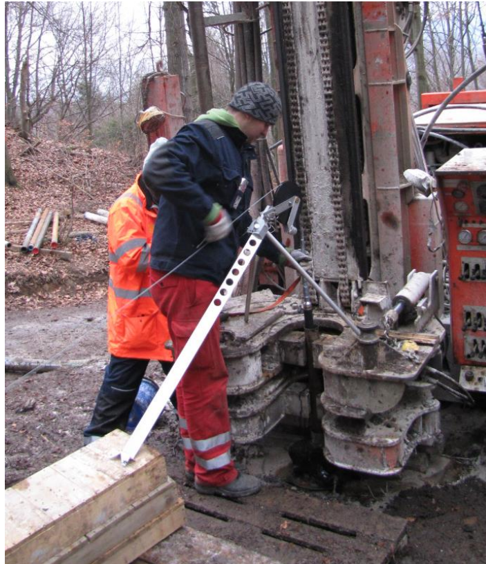
Obrázok 1 Zapúšťanie karotážnej sondy do vrtu
