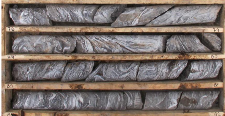
Obrázok 7 Tektonicky porušené, zbridičnaté a detailne zvrásnené slienité vápence s preplástkami zbridičnatých vápničných ílovcov
