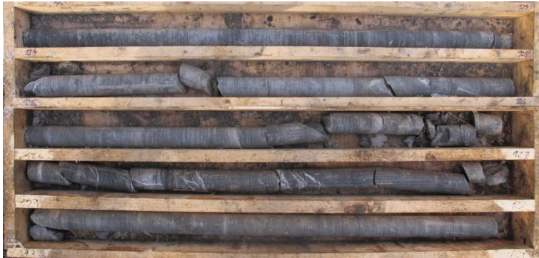
Obrázok 6 Kompaktné zdravé málo porušené ílovce s lamínami siltovca
