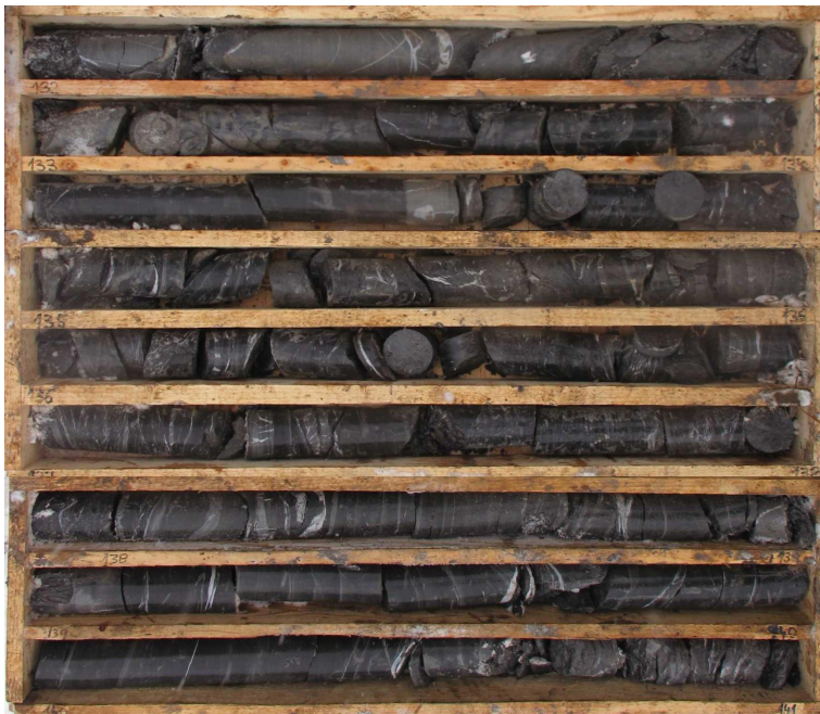
Obrázok 5 Rozpukané navetrané ílovce s lamínami siltovca, rozpadavé pozdĺž plôch vrstevnatosti
