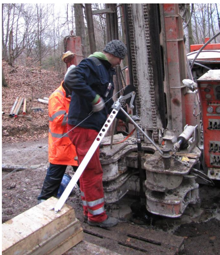
Ilustračný obrázok 1: Spúšťanie karotážnej sondy do vrtu
