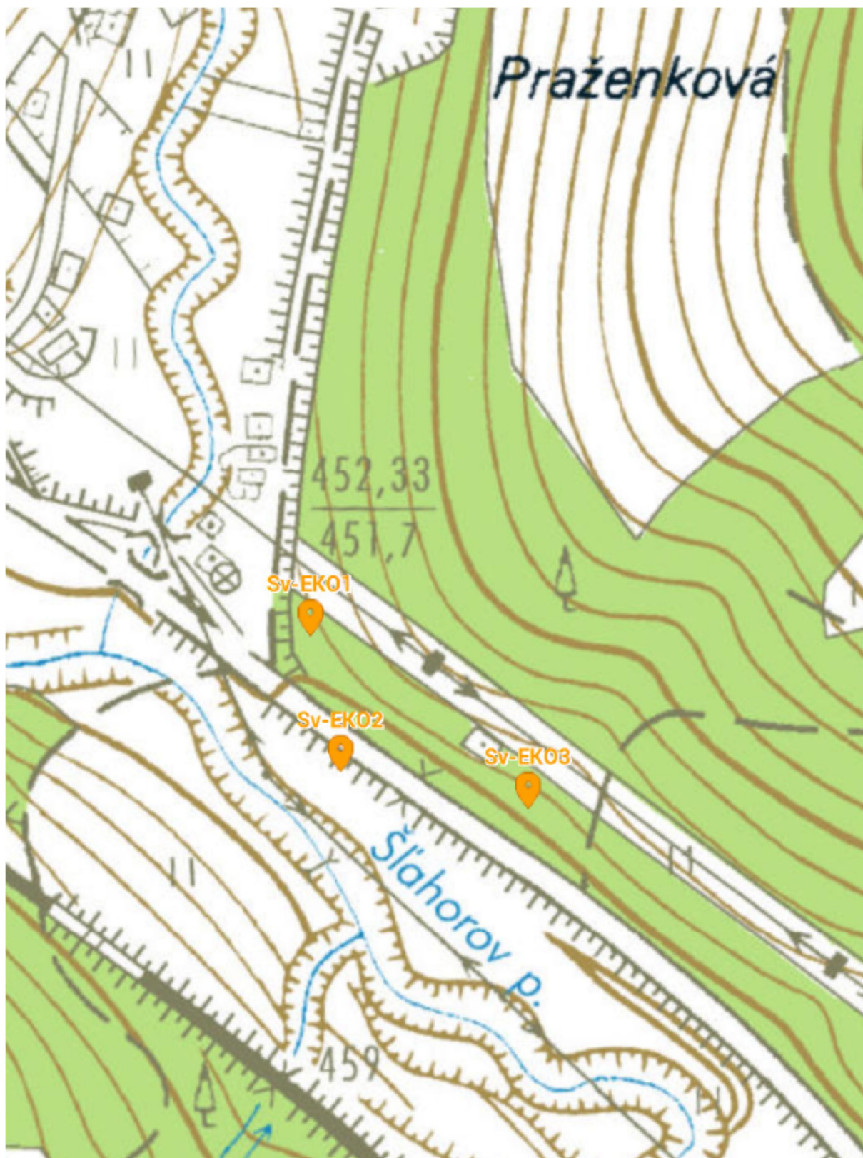
Obr. č. 1: Situácia bodov meraní geoelektrického korózneho prieskumu, M = 1 : 2\,500
