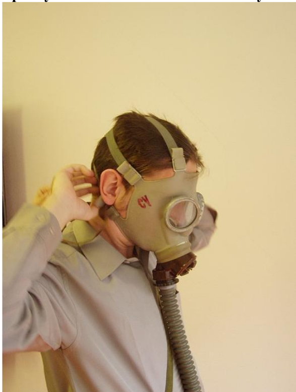
12. Podľa potreby dotiahneme upínacie pásy cez hlavu – začíname od dolných
